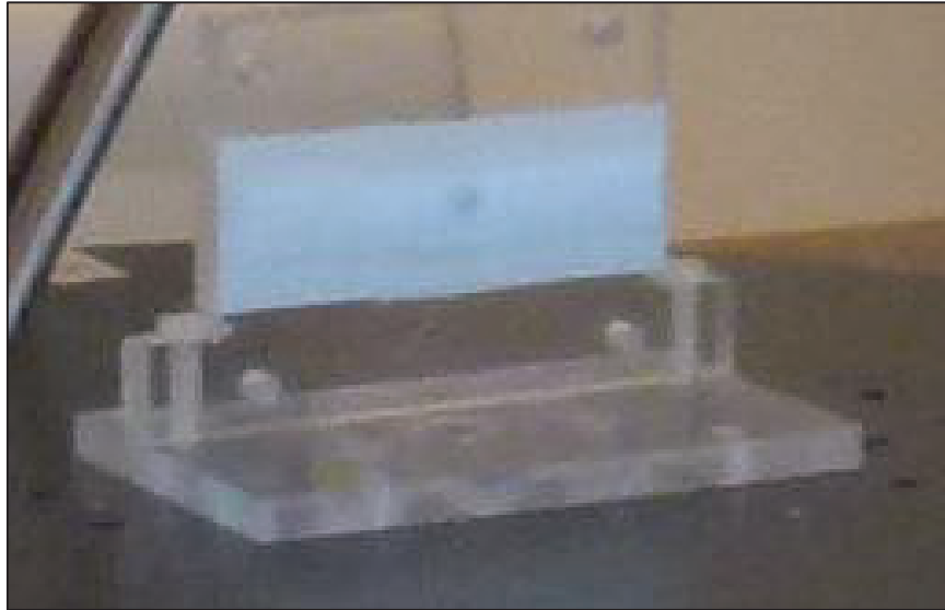
図 6：試験装置、ねじりばねを用いた試験セットアップ
